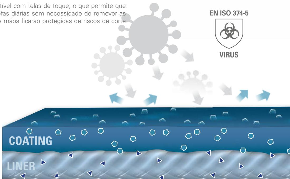
Ilustração esquemática do corte transversal da luua – muito aumentada
